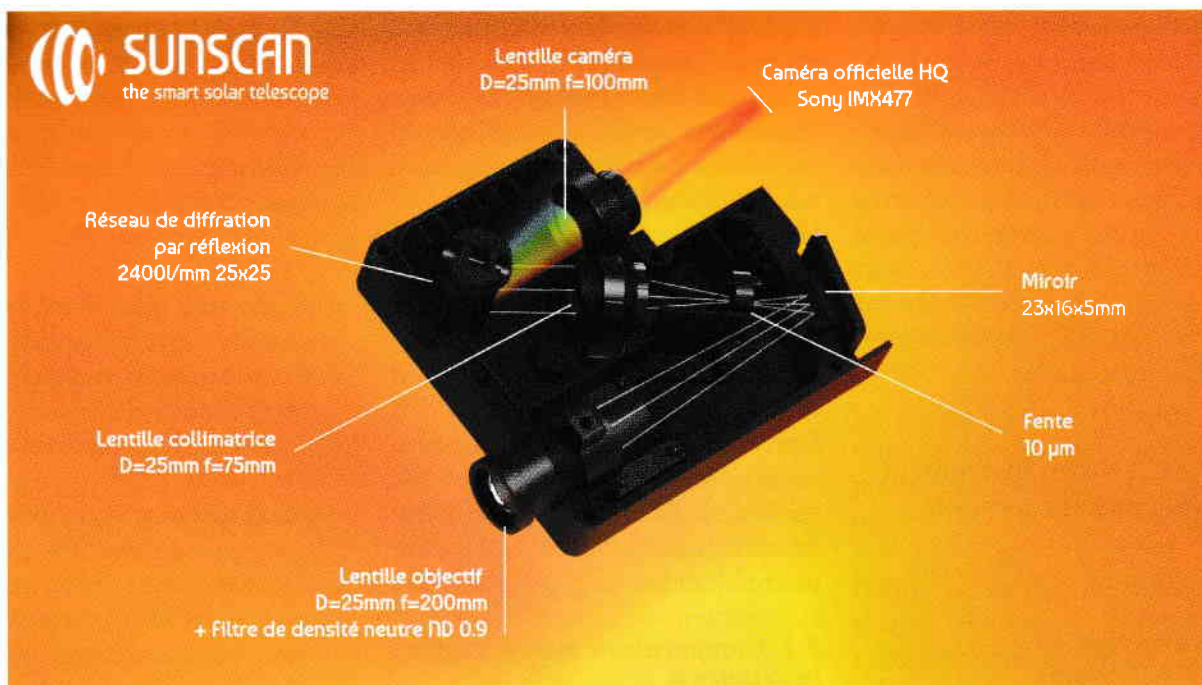
Fig 2 : Schéma interne du SUNSCAN : vue en coupe de l'instrument montrant les principales pièces optiques ainsi que le chemin suivi par la lumière solaire depuis l'objectif jusqu'au capteur (crédit : STAROS projects) [2].
